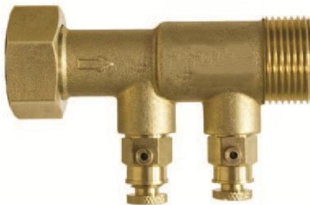
Le clapet anti-pollution **Palm-stop'™** est destiné à la protection de vos branchements eau potable contre le retour de fluides potentiellement pollués. Son ouverture est automatique dans le sens de l'écoulement sous l'effet de la pression amont. En cas d'arrêt de l'écoulement, ou en cas de pression supérieure en aval, **le clapet se referme instantanément et automatiquement**. Votre réseau est désormais protégé du risque de pollution en provenance du réseau aval !
